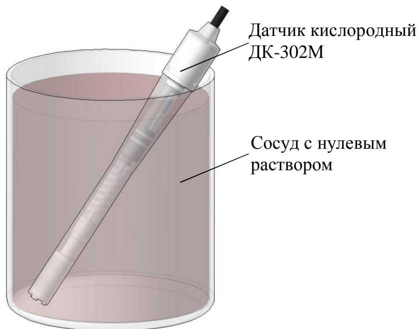
Рисунок 2.11 – Проверка показаний в «нулевом» растворе
