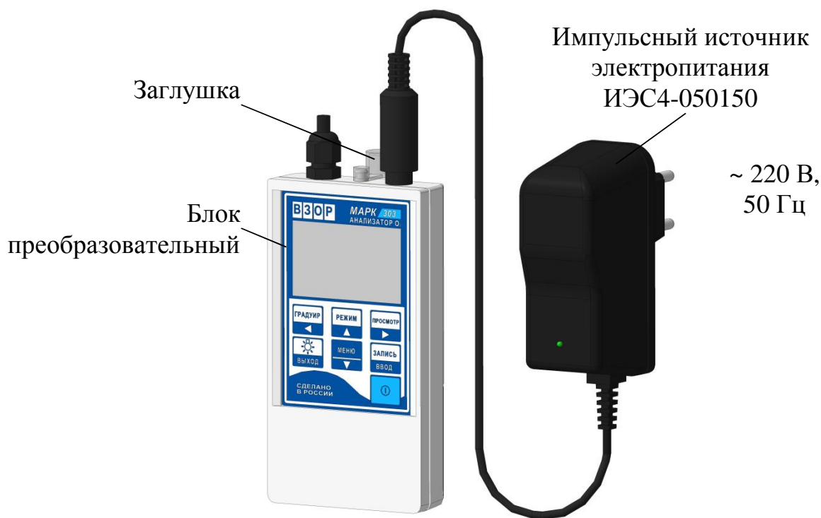
Рисунок 3.2 – Зарядка аккумуляторных батарей
